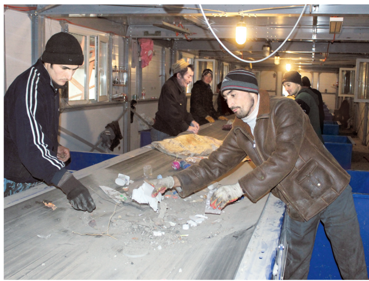
Конвейерная лента мусоросортировочного завода
